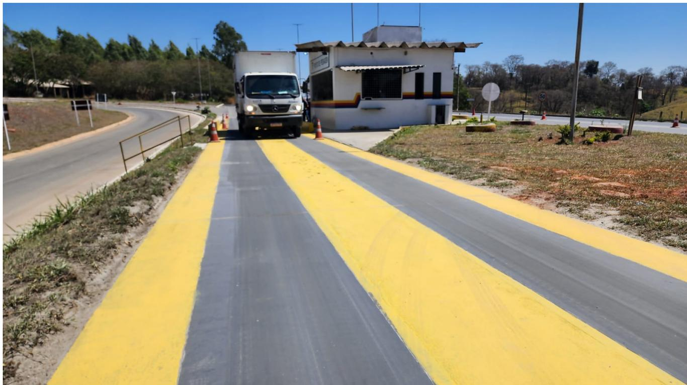
Para garantir que a verificação seja realizada de forma totalmente segura, a passagem dos veículos pela balança é feita, no mínimo, cinco vezes e em velocidades distintas, conforme previsto na Portaria INMETRO nº 19, de 12 de janeiro de 2022.
